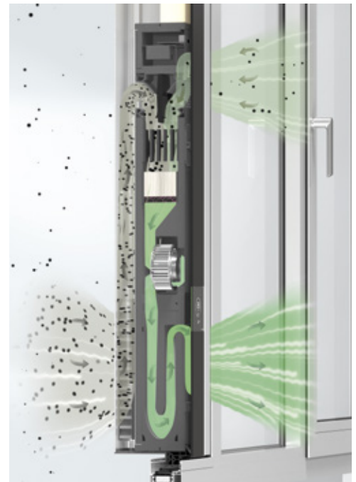
Aufbau des Schüco VentoLife mit Luftführung Configuration of Schüco VentoLife with air circulation
